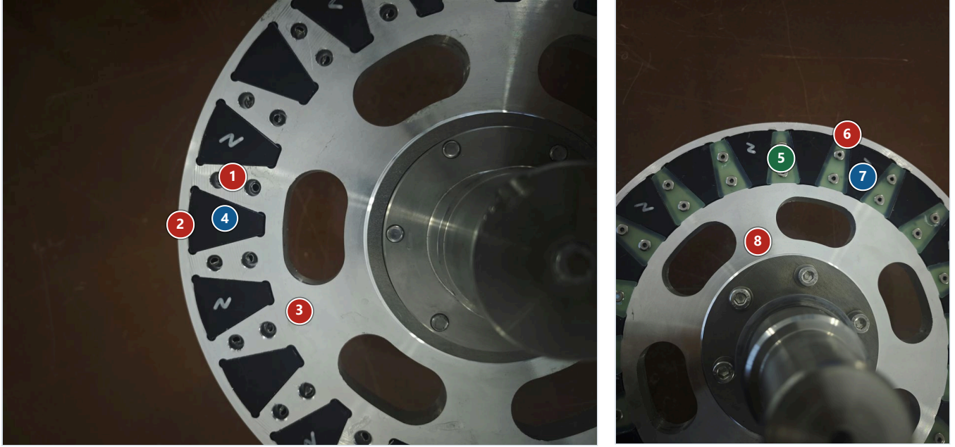
Şekil 1 — Sol: A yüzü. Sağ: B yüzü. 1 Al ağ (perçinli) · 2 dış bilezik · 3 iç halka · 4 mıknatıs (tek parça) · 5 FR4/G10 dış · 6 dış bilezik · 7 mıknatıs · 8 iç halka (Al). Kırmızı: alüminyum, yeşil: yalıtkan, mavi: mıknatıs.
